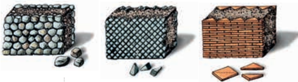
↓ Fig. 24.5 Sistemi di muratura dell'architettura romana: opus incertum , opus reticulatum , opus testaceum o latericium .
